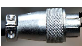
Stecker passt nur in einer Position in das Steuergerät
